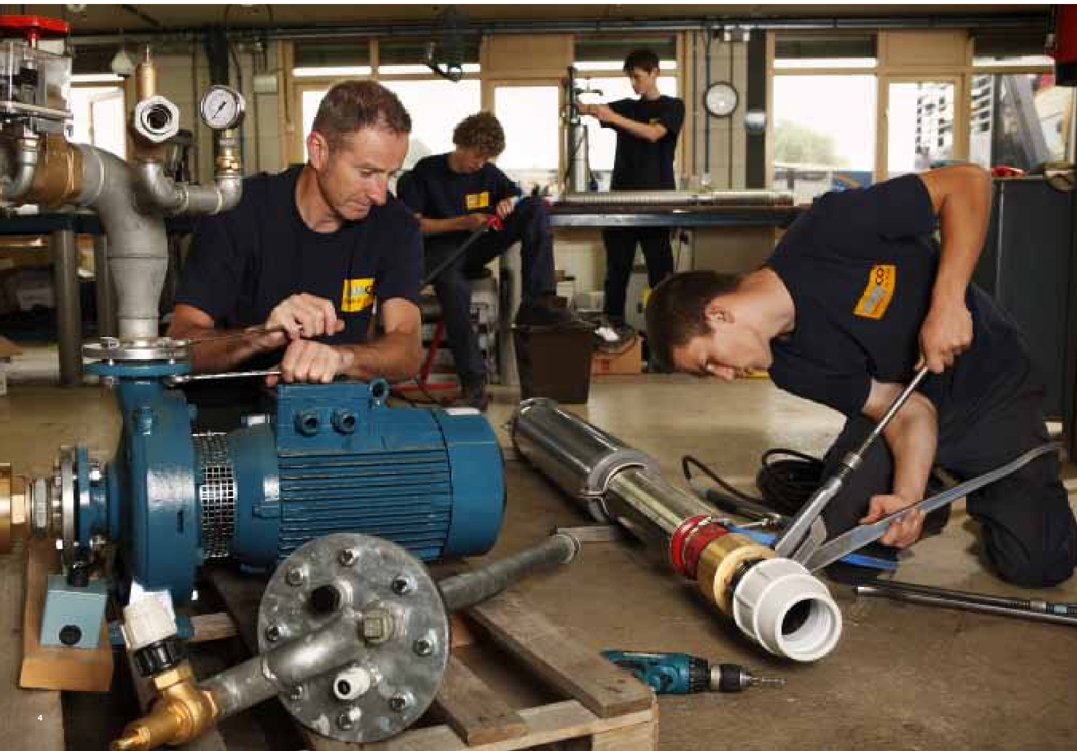
René, Jeff, Marco en Joost in de werkplaats van Aquaco. Ze zijn bezig met de afmontage van twee pompen en het maken van een kabellas.
